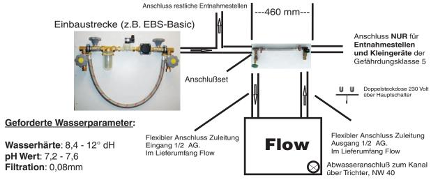
Für den ordnungsgemäßen Betrieb sowie für die Wahrung von Garantieansprüchen ist die Einhaltung der nachstehend aufgeführten Wasserparameter Voraussetzung. Bei einer Überschreitung des Wasserhärtewertes droht Verkalkung, bei einer Unterschreitung drohen Probleme durch organische Ablagerungen.
